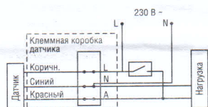
Рисунок 20. Схема режима постоянного включения нагрузки
