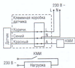
Рисунок 21. Схема подключения датчика с контактором КМИ
